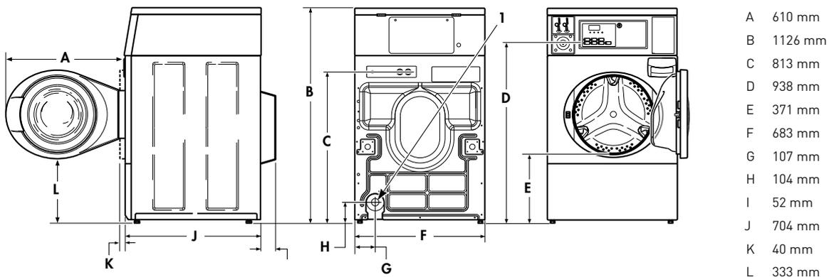
1 38mm – diamètre d'intérieur; 47mm – diamètre extérieur
